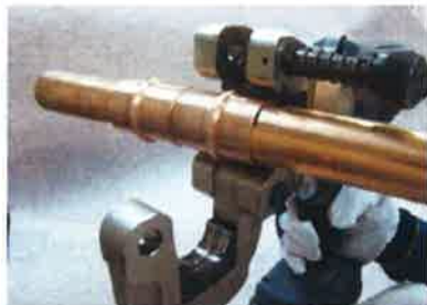
①リングドームをダイス凹部に合わせる
