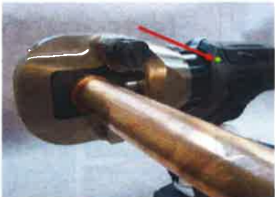
⑥プレス完了 - 状態表示ランプが緑点灯
