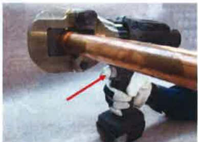
⑤プレス開始 - 作動スイッチ(灰色)を押す
